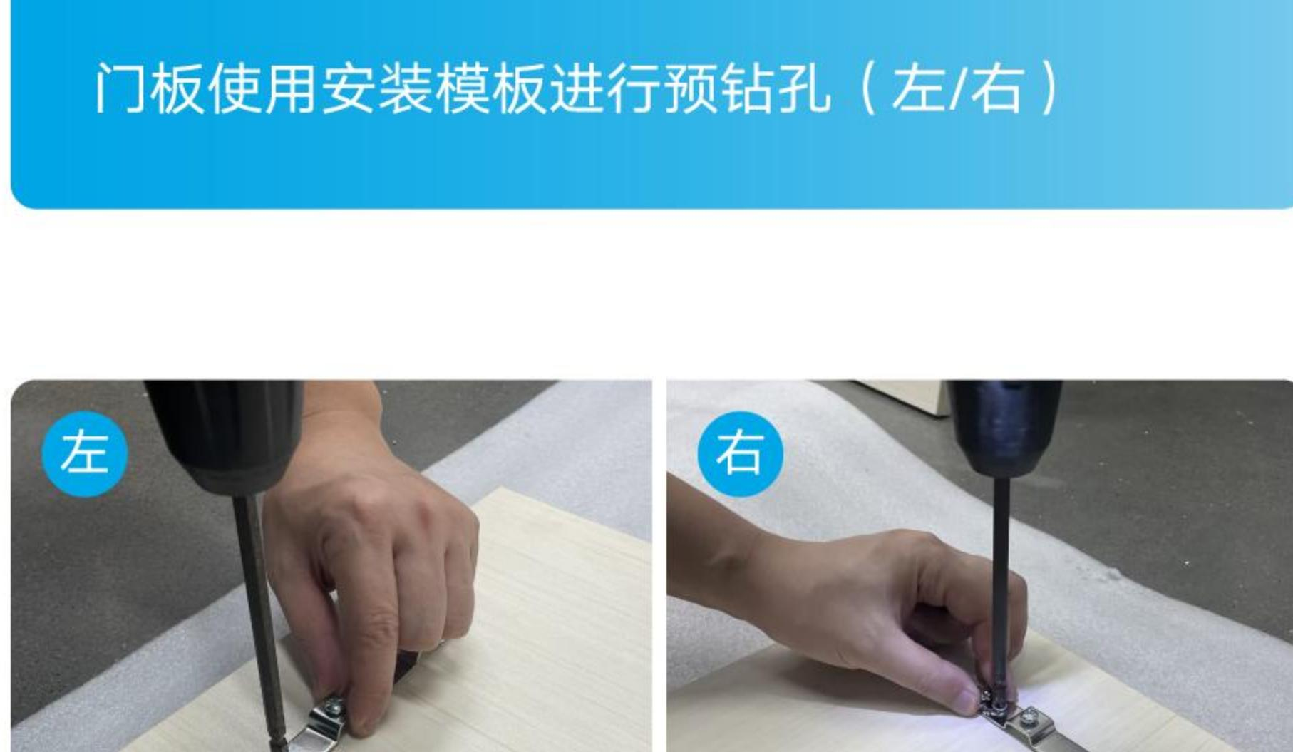
门板使用安装模板进行预钻孔（左/右）
