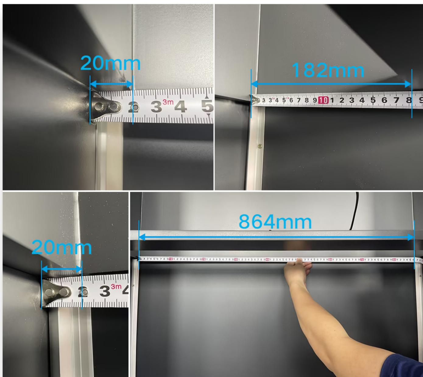
预留底部孔，孔位尺寸864mm\*182mm，孔到柜边距长边和宽边各预留20mm
