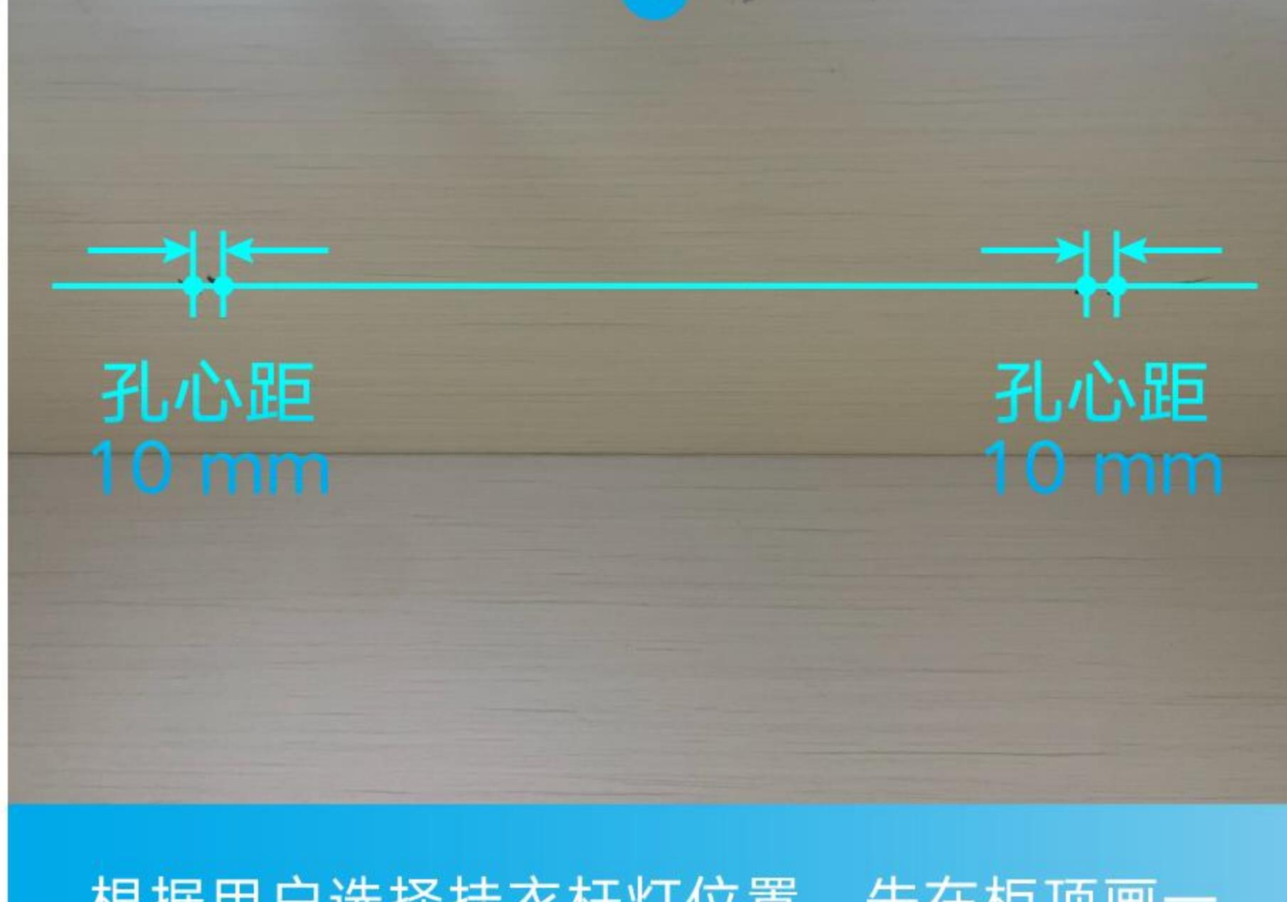
根据用户选择挂衣杆灯位置，先在柜顶画一条水平线，按挂衣杆长度，在平行线上根据底座螺纹孔打点（底座螺纹孔中心距 10mm）
