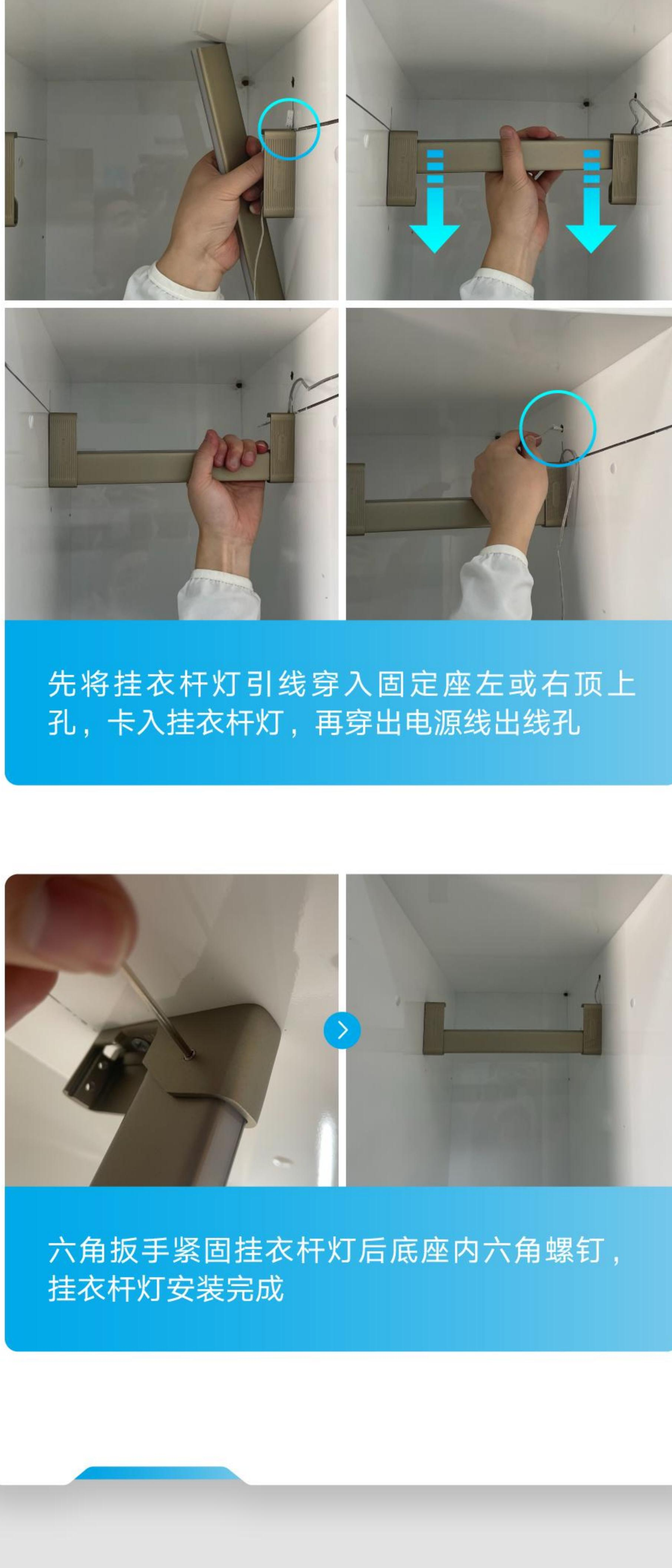
先将挂衣杆灯引线穿入固定座左或右顶上孔，卡入挂衣杆灯，再穿出电源线出线孔
