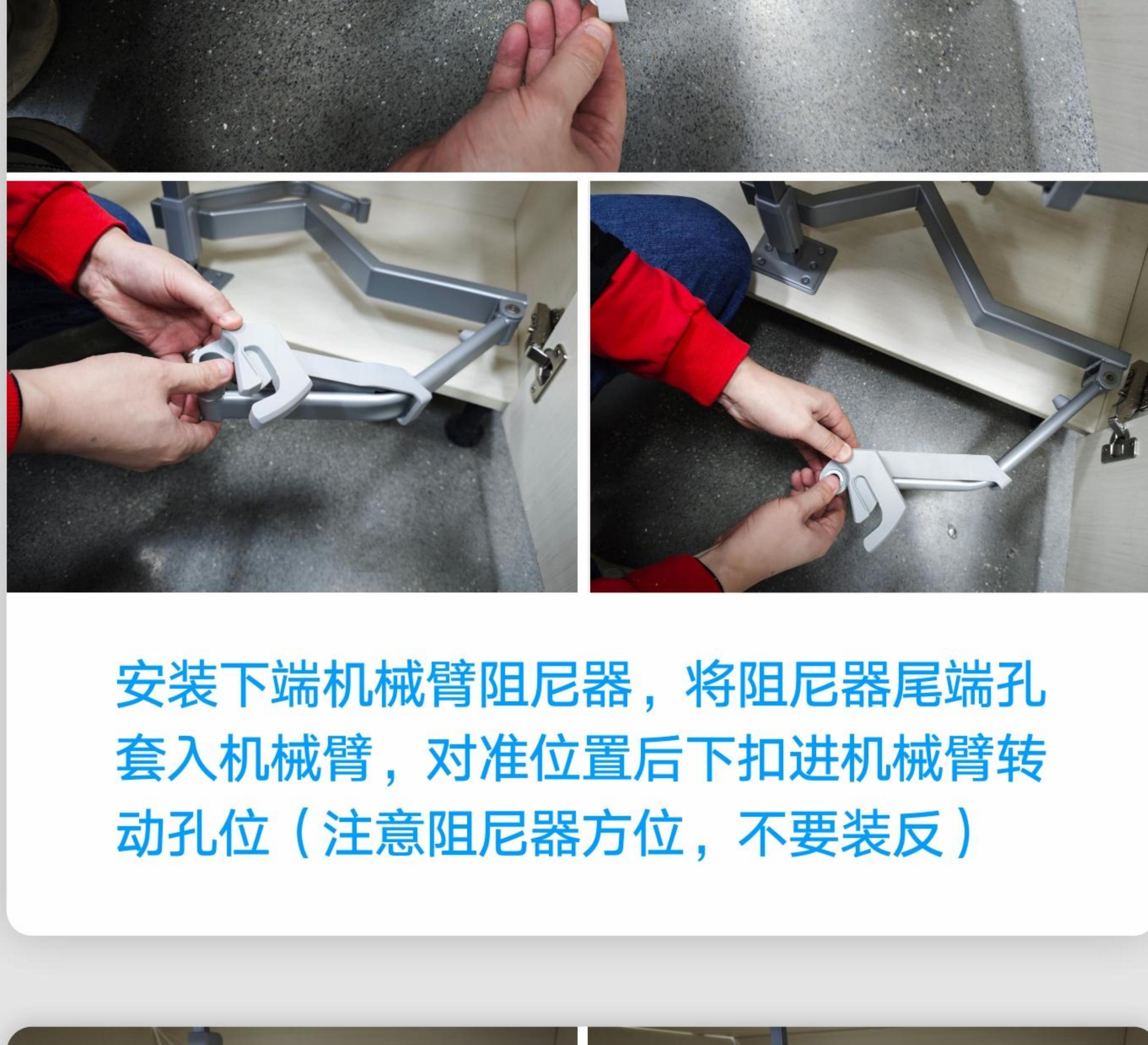
安装下端机械臂阻尼器，将阻尼器尾端孔套入机械臂，对准位置后下扣进机械臂转动孔位（注意阻尼器方位，不要装反）
