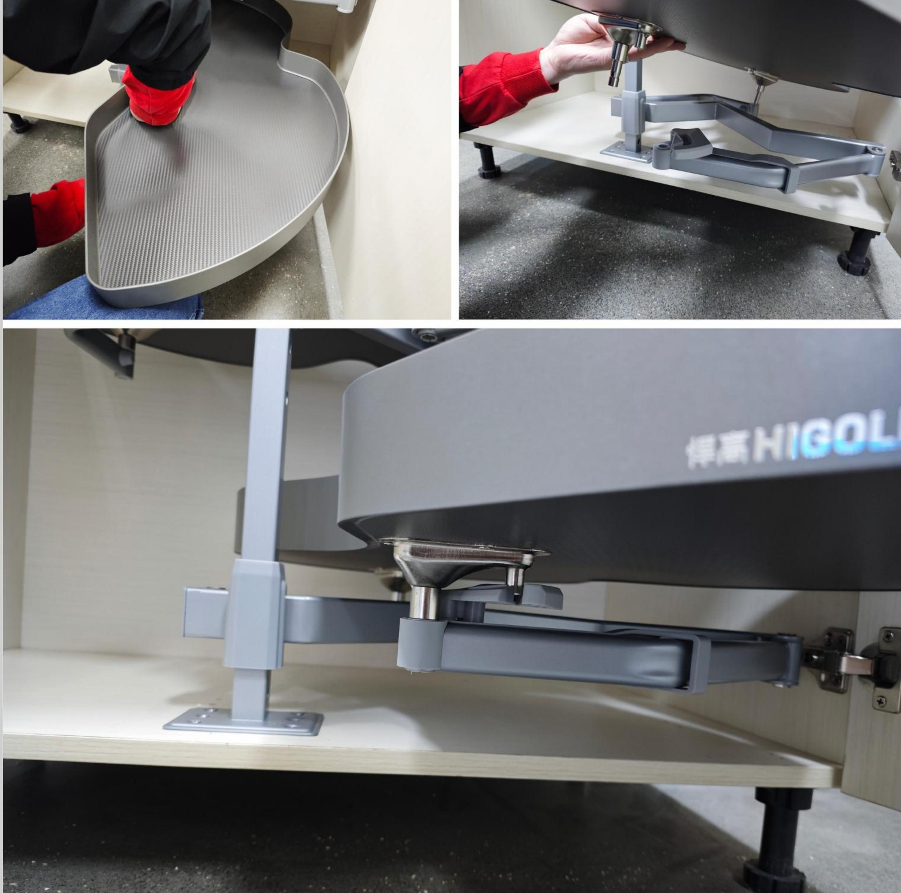
飞碟篮下端装配，将飞碟篮转动销轴对准下端机械臂的两个孔位进行安装，同步调整阻尼器活动滑槽，确保短销轴在阻尼器滑槽内，完成后按压飞碟篮，确保销轴装配到位
