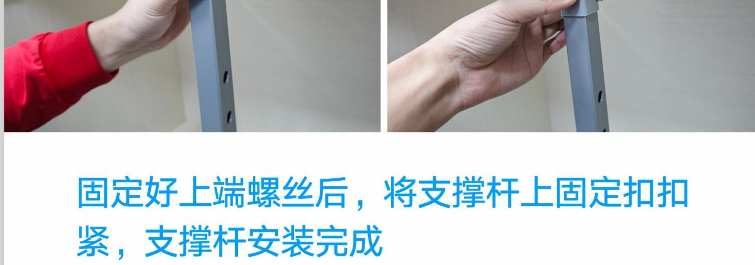
固定好上端螺丝后，将支撑杆上固定扣扣紧，支撑杆安装完成
