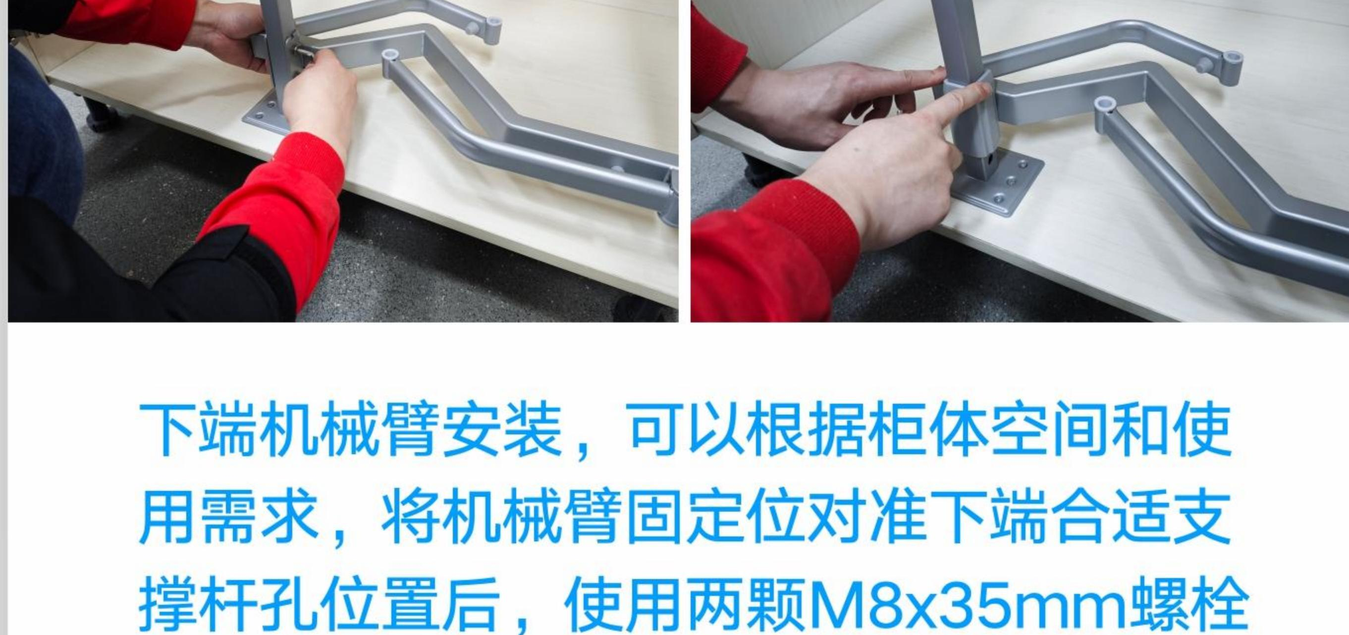
下端机械臂安装，可以根据柜体空间和使用需求，将机械臂固定位对准下端合适支撑杆孔位置后，使用两颗M8x35mm螺栓固定机械臂，固定完成将装饰盖从上扣入支撑杆，滑入扣上机械臂螺钉固定位
