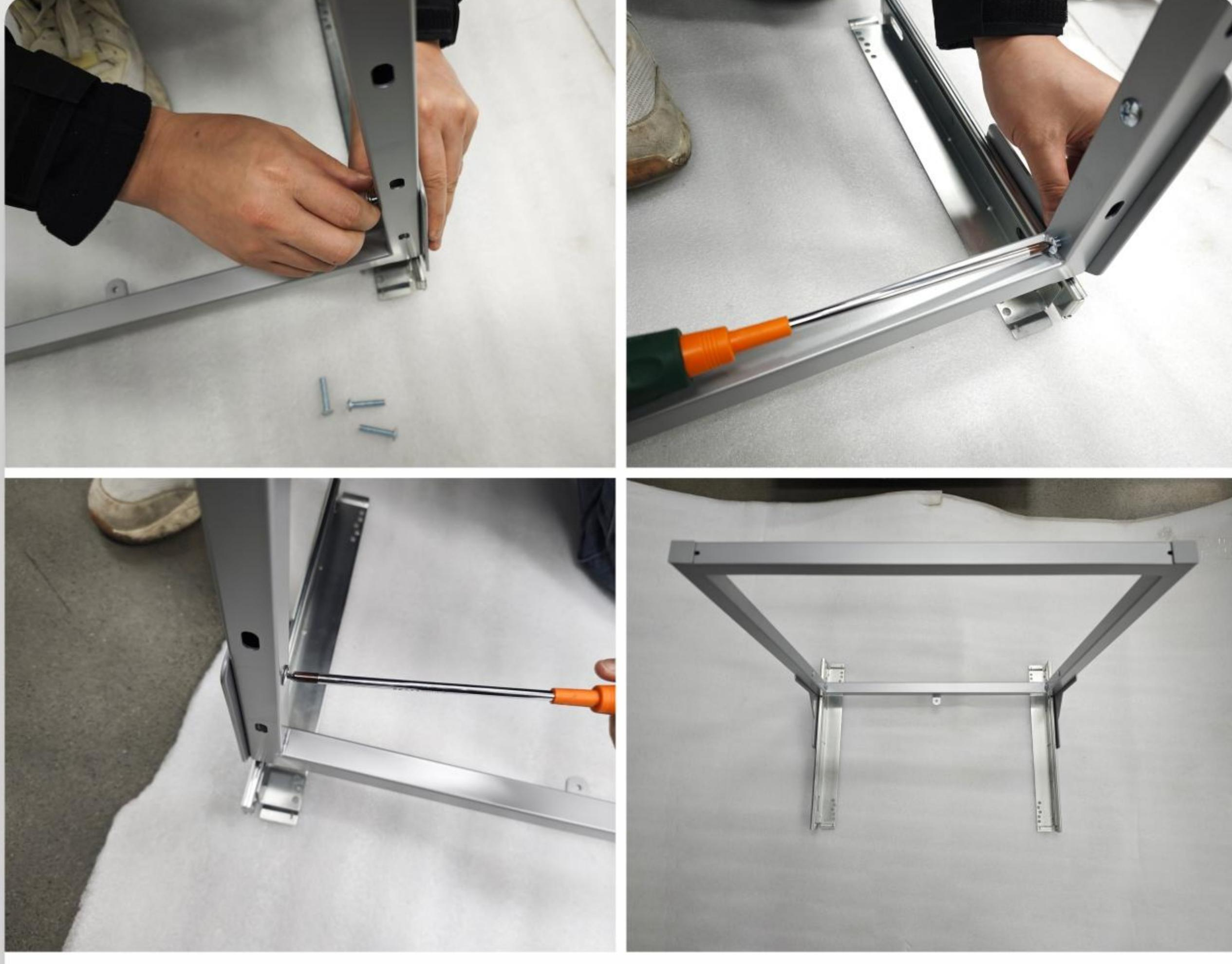
主框架与L形板组装，在主框架孔位对准L型板孔位，穿入M6\*30螺钉，左右螺钉锁紧。
