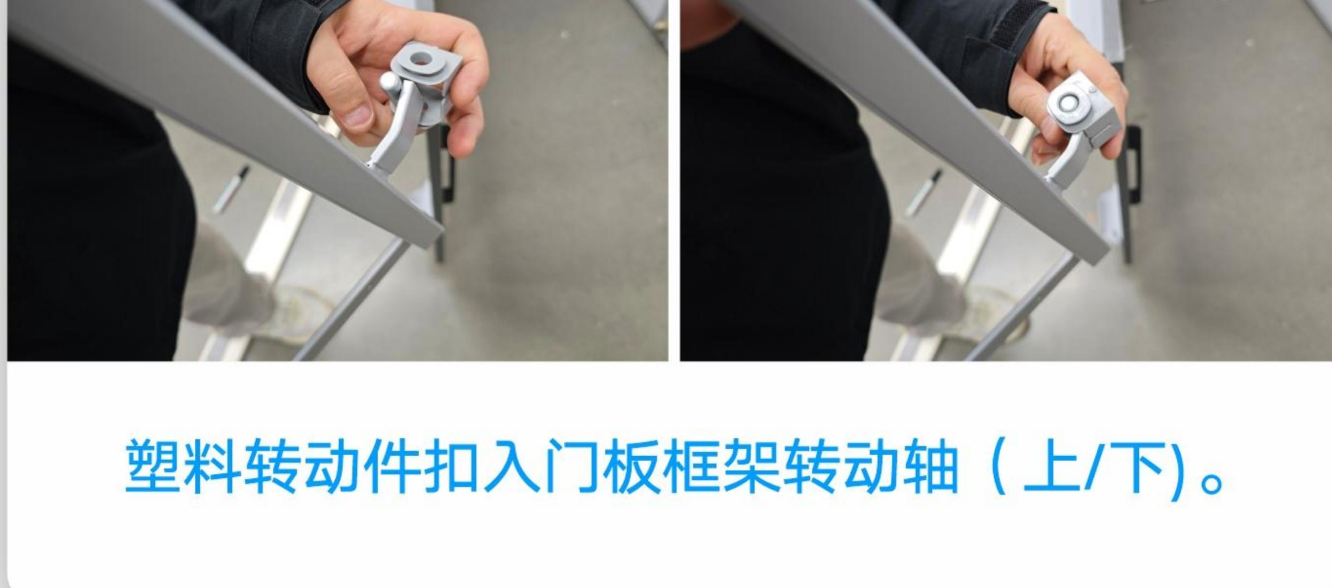
塑料转动件扣入门板框架转动轴（上/下）。
