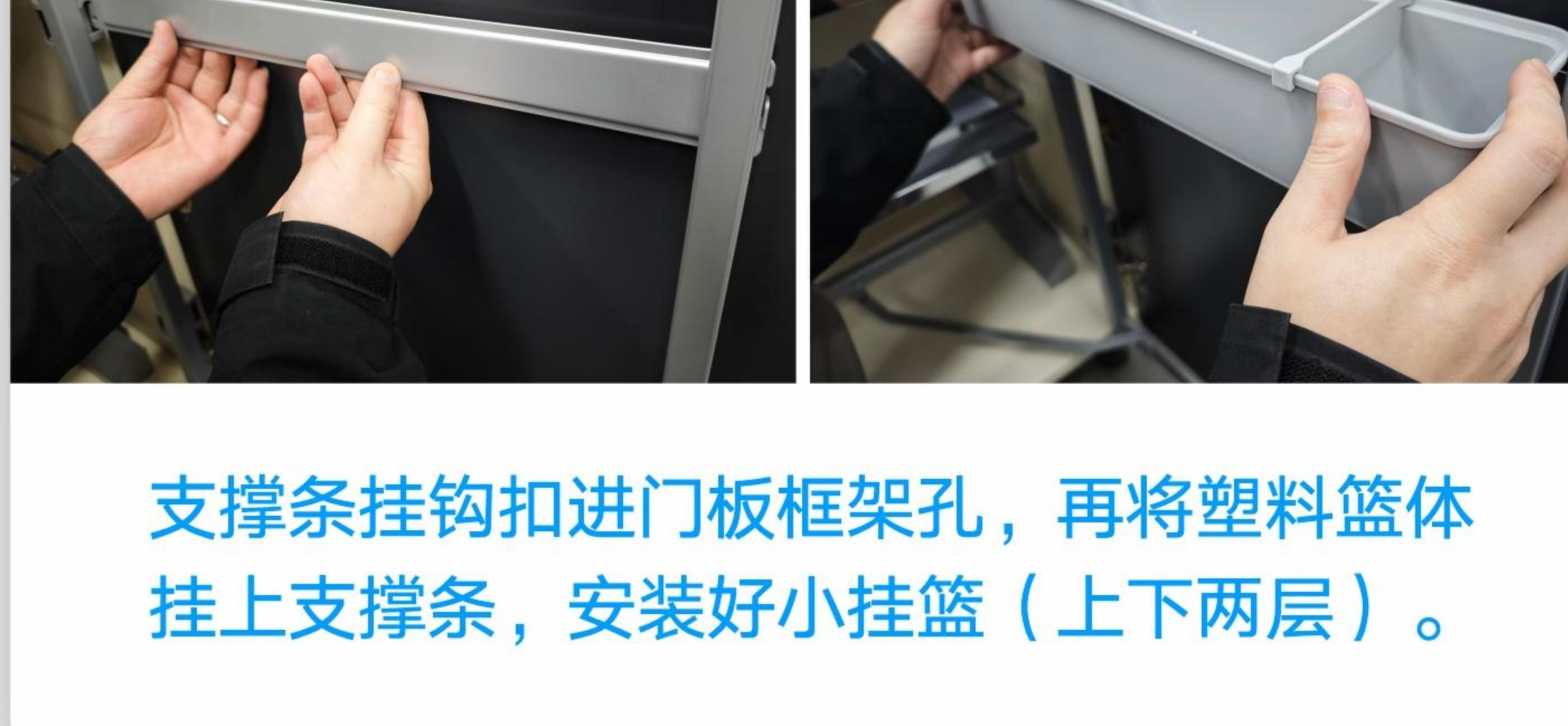
支撑条挂钩扣进门板框架孔，再将塑料篮体挂上支撑条，安装好小挂篮（上下两层）。
