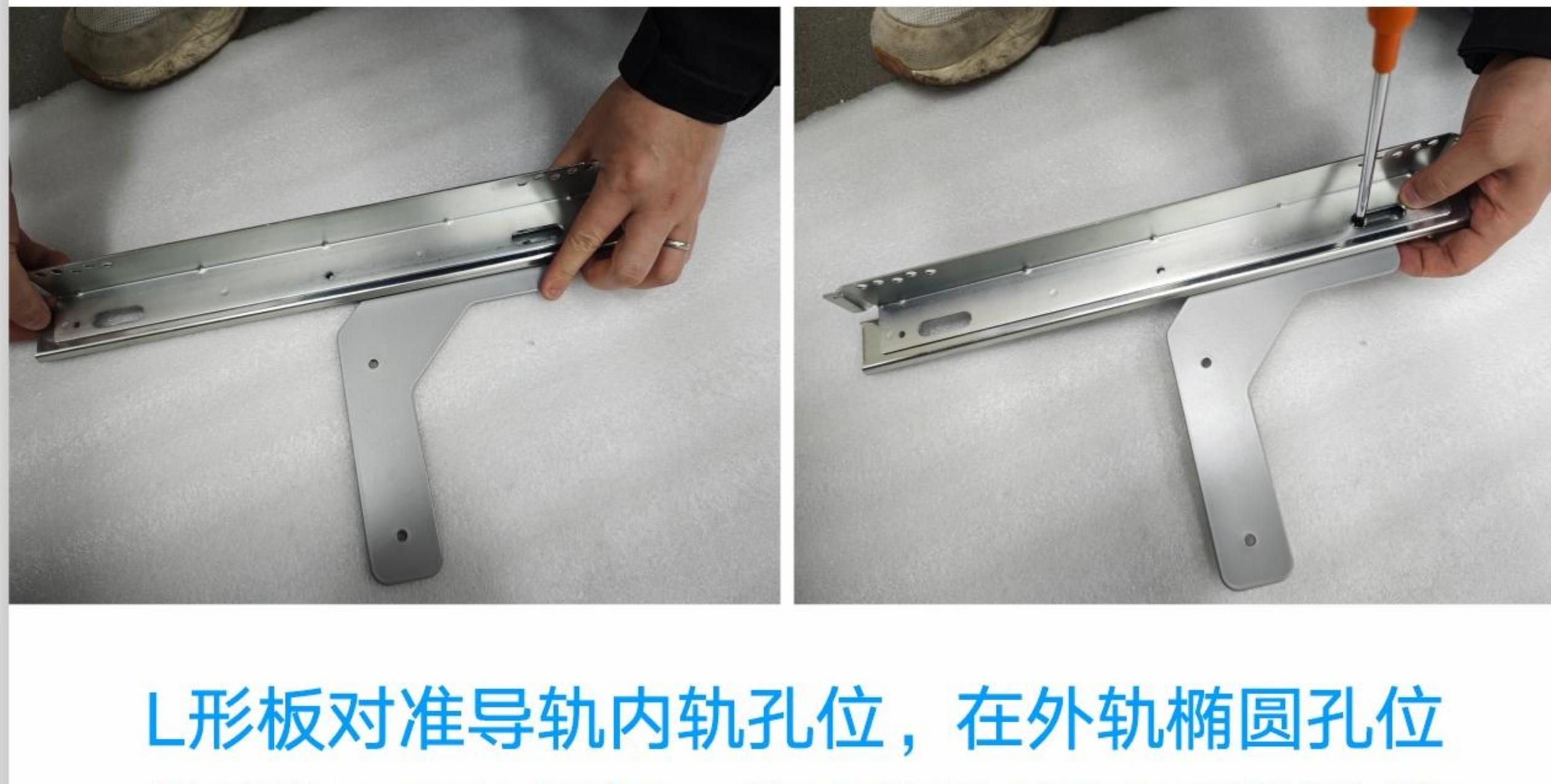
L形板对准导轨内轨孔位，在外轨椭圆孔位
