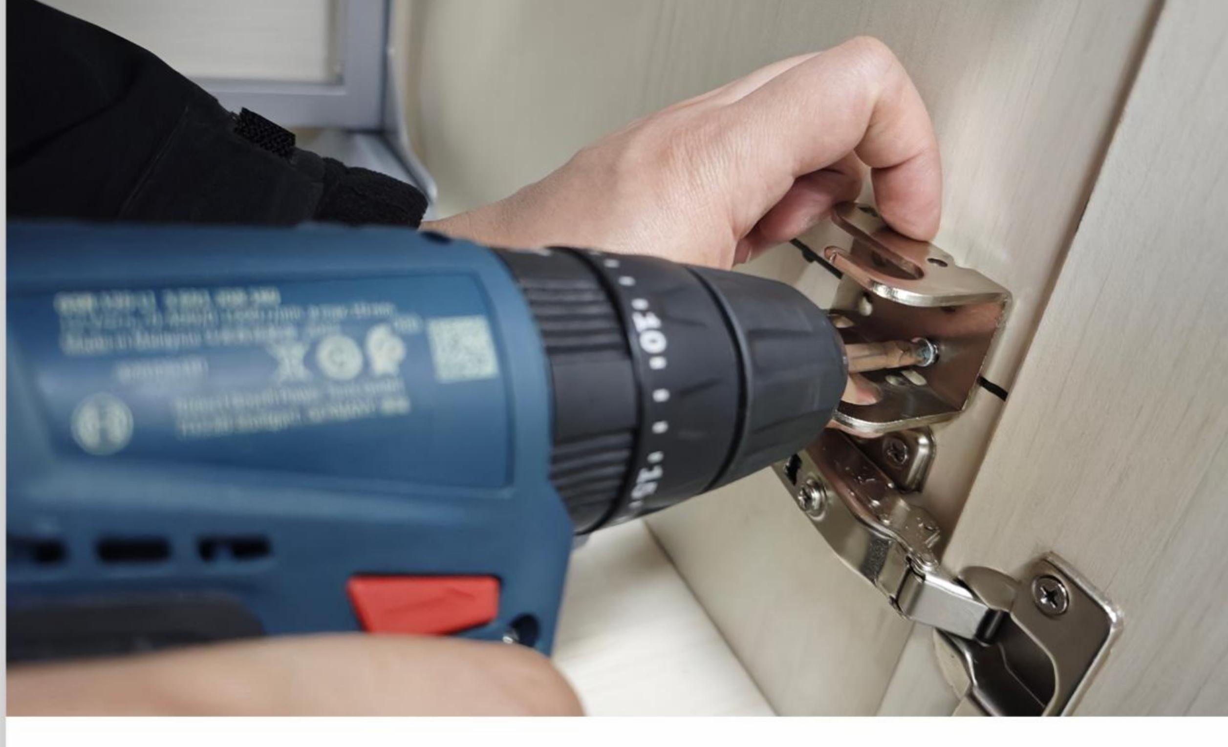
在第一条基准线上，距离柜边21mm处确定基准点，使用ST4.0\*16自攻螺钉对准基准点固定下部转动底座。
