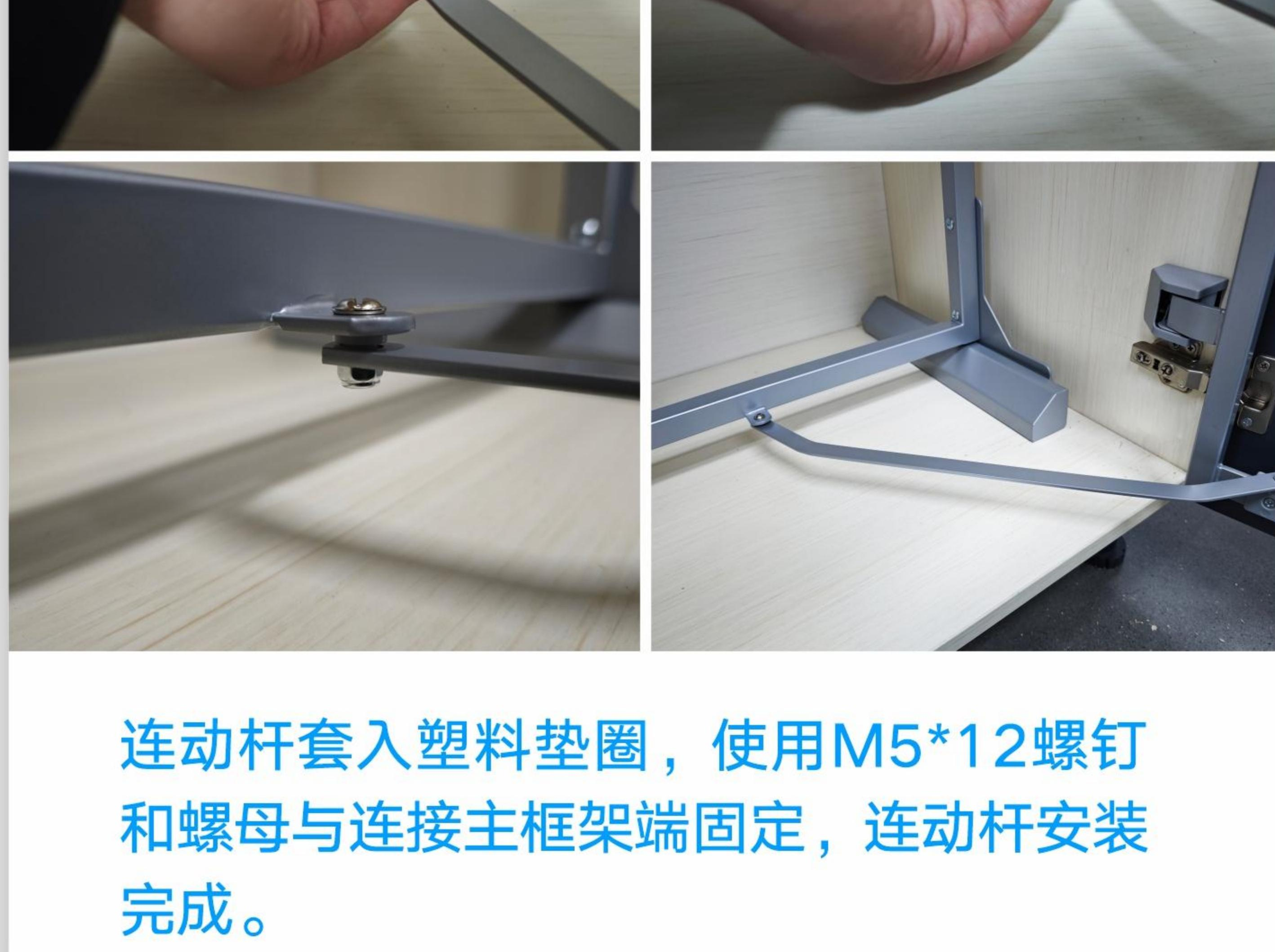
连动杆套入塑料垫圈，使用M5\*12螺钉和螺母与连接主框架端固定，连动杆安装完成。
