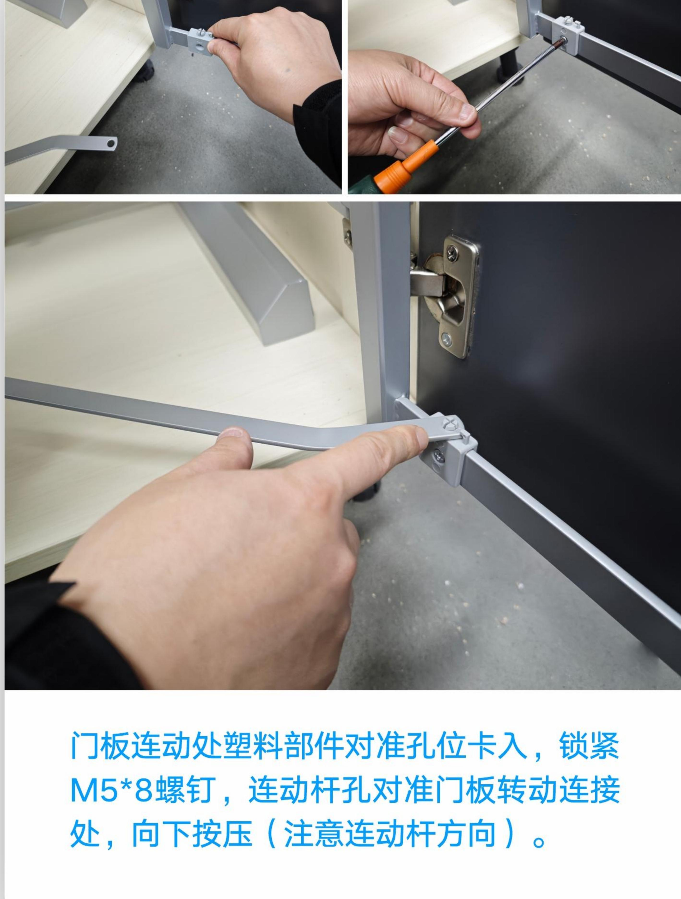
门板连动处塑料部件对准孔位卡入，锁紧 M5\*8螺钉，连动杆孔对准门板转动连接处，向下按压（注意连动杆方向）。
