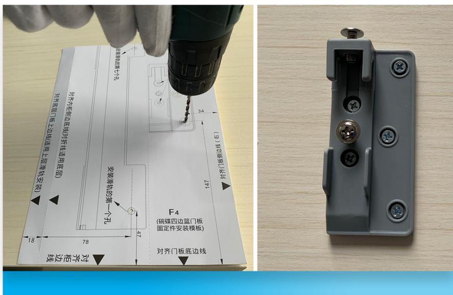
门板连接件预钻孔及固定（左右）
